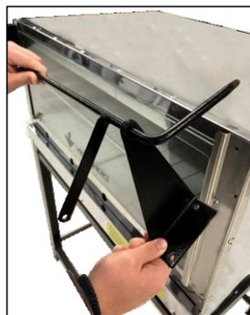
4) Encaixe o parafuso juntamente com o bracinho maior conforme a (fig.4 e 5), lembrando de não efetuar o aperto por completo, pois é necessário deixar uma folga, para que possa movimentar todo o sistema.
