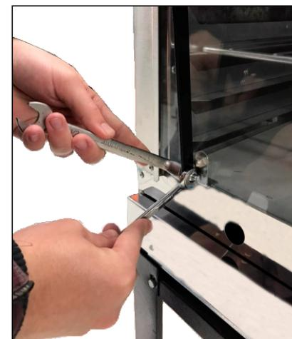
7) Após realizado o processo em ambos os lados, rosqueie, no sentido horário, os pesos nas duas extremidades do eixo, conforme demonstrado na fig.8. (Fig.8)
