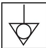
O símbolo ao lado indica o terminal de ligação equipotencial, destinado à ligação do equipamento via condutor elétrico a outros pontos de ligação equipotencial, tais como equipamentos, bancadas, edificações, mantendo-se deste forma o equilíbrio entre diferentes pontos de ligação, minimizando possíveis riscos de choque elétrico. Este terminal permite a conexão de um cabo de seção nominal de 10mm<sup>2</sup>.
